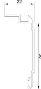
روکوب ۵۰ Suppressed the binding Code : 10027 weight : 0.29 kg/m
